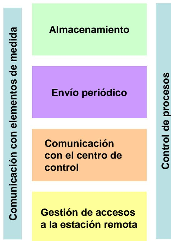
Fig. 5 Diagrama de procesos de la estación remota.
